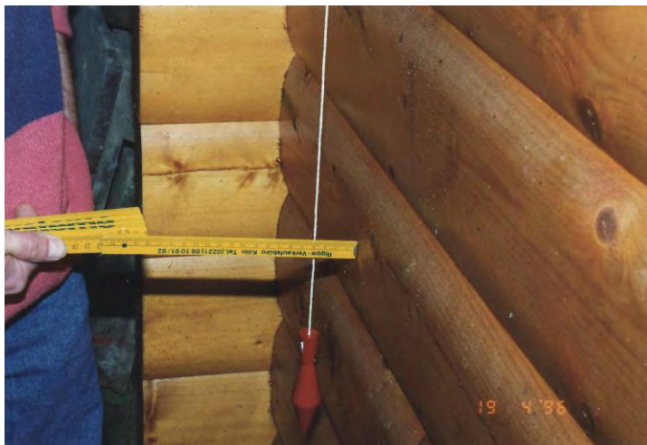
Bild 1: Messung der Schiefstellung der südlichen Traufwand
