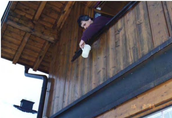
Bild 3: Wasserbeaufschlagung im Obergeschoß der westlichen Giebelwand
