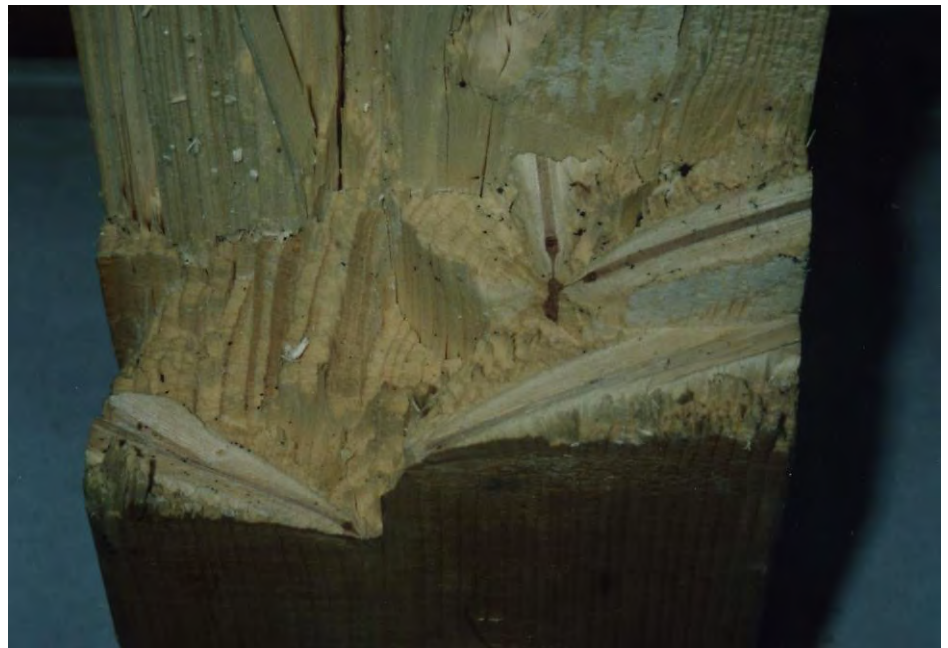
Bild 2.1-2 Unzulässige Astansammlung in einer Brettschichtholzlamelle [Foto: Schmidt]
