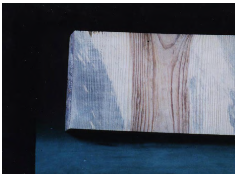
Bild 6.1-3 Befall des Splintholzes durch Bläue
