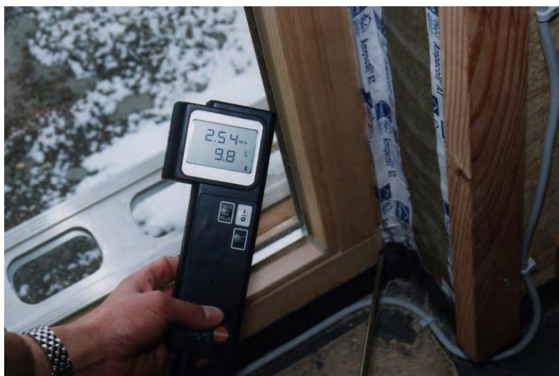
Bild 5.4-14 Anemometer: Messung der Luftgeschwindigkeit in m/s
